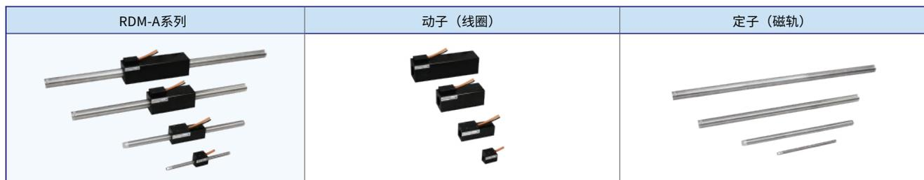
对于棒状电机结构，其磁力线沿磁铁周向均匀分布，其线圈是圆形并在轴向方向互相紧贴排布。对于RDM-A系列，线圈与磁轴之间存在气隙，可实现轴向无接触式直线运动。
